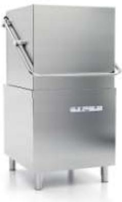
Посудомоечная машина купольного типа с дозаторами ополаскивающего и моющего средства, стенки одинарные, электромеханическая панель управления, производительность 900 тар/ч, корзина 500x500, продолжительность цикла 180 сек, цикл мойки: один, подключение к воде 15-50С, вместимость бака 22 л, мощность помпы 0,71 кВт; цикл ополаскивания: длительность 14 сек, температура ополаскивания 82С, потребление воды 3л; максимальная высота загрузки 400 мм
