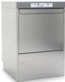
Фронтальная посудомоечная машина с дозатором ополаскивающего средства, стенки двойные, электромеханическая панель управления, производительность 500 тар/ч, корзина 500x500 мм, продолжительность цикла 180 сек, цикл мойки: один, подключение к воде 50С, вместимость бака 24 л, мощность помпы 0,43 кВт, цикл ополаскивания: длительность 14 сек, температура ополаскивания 82С, потребление воды 3л; максимальная высота загрузки 360 мм.
